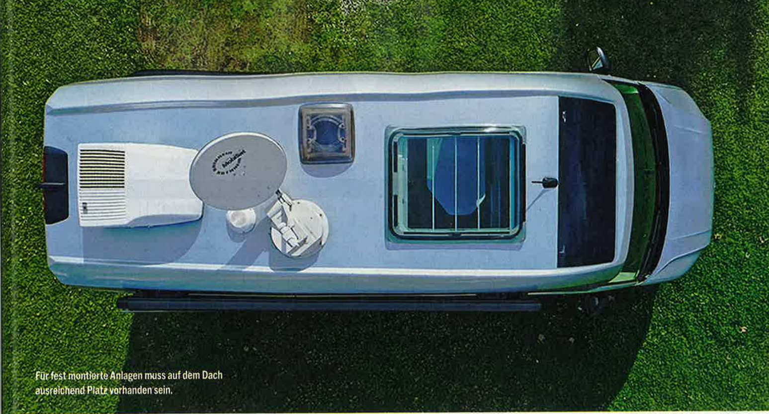
Zwischen 15 und knapp 20 Zentimeter hoch sind die meisten Sat-Anlagen im eingeklappten Zustand.
